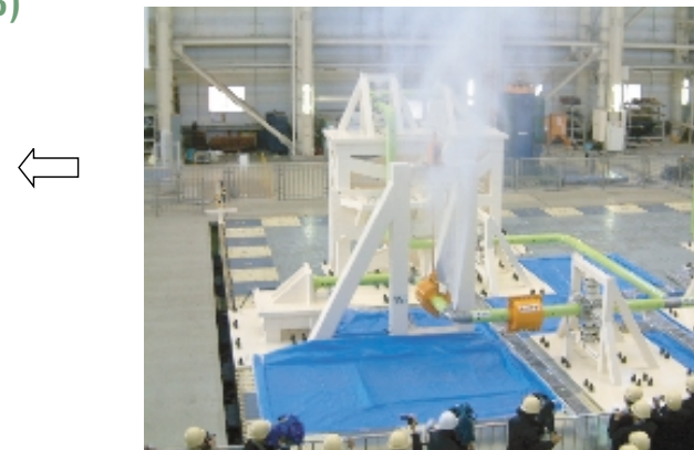
Test of Actual Scale Piping System
